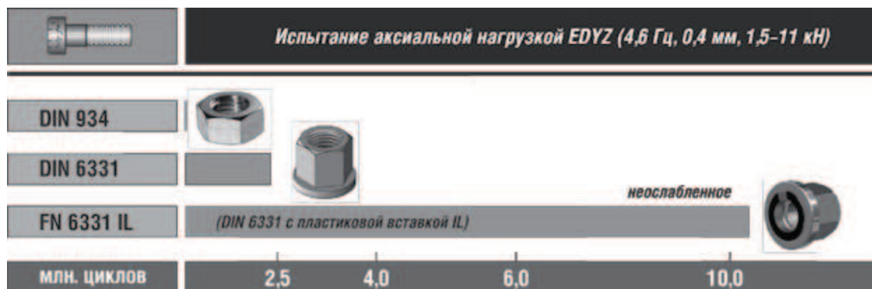
Рис. 3. Уменьшение усилия затяжки резьбового соединения после испытания динамической аксиальной нагрузкой EDYZ (M20, кл. 10) [5]
