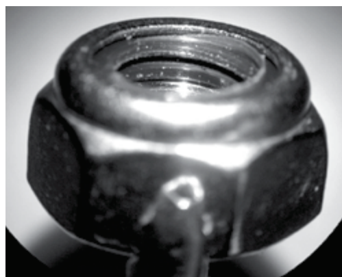
Рис. 7. Стопорная гайка DIN 985 с повреждённым нейлоновым кольцом
