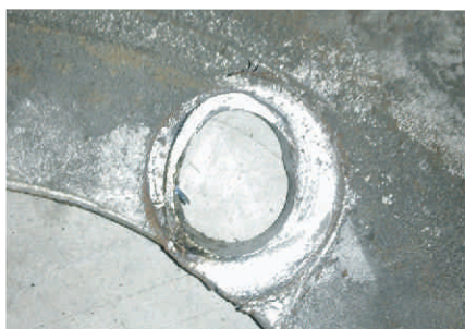
Obr. 1 Vyklepaný otvor v disku kola v 10. kole na Veľkej cene (Malaysia). Nutné podotknúť, že po poklese montážneho predpätia sa najprv v disku vytvorí oválny otvor (obr. 1), prejavujúci sa neidentifikova-
